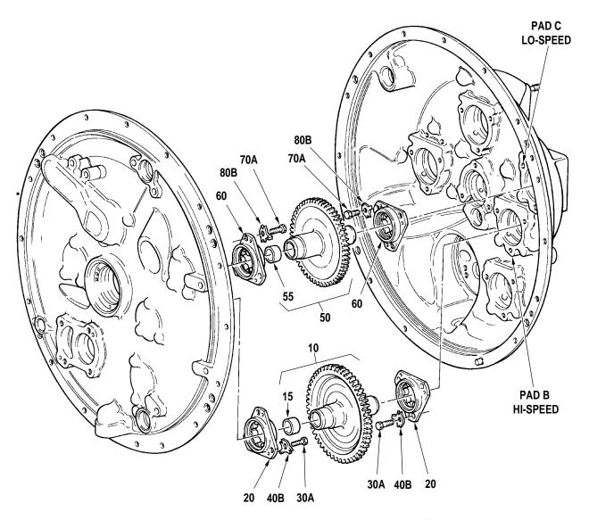
NOTE: LOW-SPEED OPTION REQUIRES THAT HI-SPEED OPTION BE INSTALLED TO DRIVE IT.
